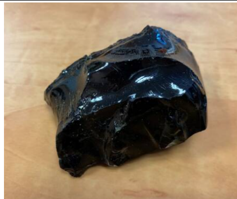
Figure 3 : Verre borosilicate contenant les déchets radioactifs
