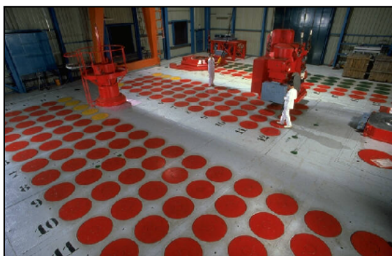
Figure 16 : Entreposage des colis de déchets vitrifiés de Marcoule
