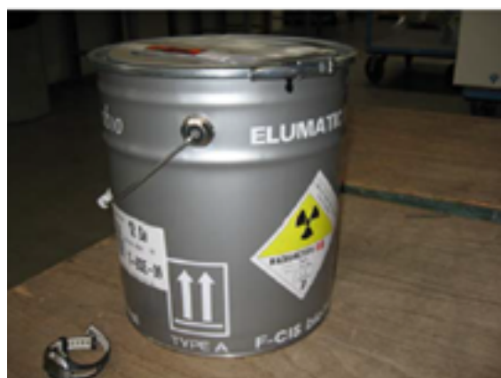
Colis ELUMATIC de Type A (générateur de technétium)
