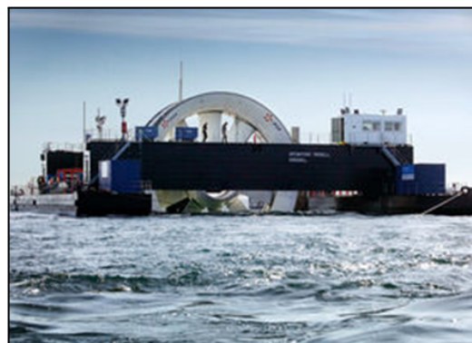
Figure 9 : Hydrolienne l'Arcouest au large de Paimpol
