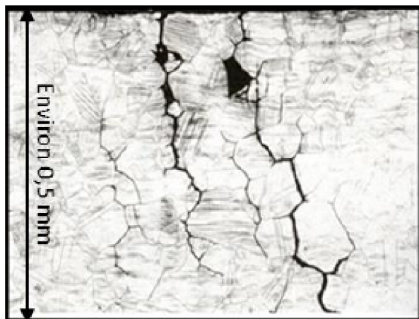
Figure 1 : Exemple de CSC dans un acier inoxydable au contact d'un fluide primaire de REP
